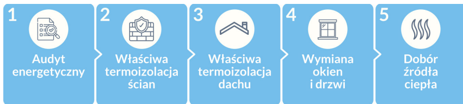
Rysunek 5: Kolejność termomodernizacji
